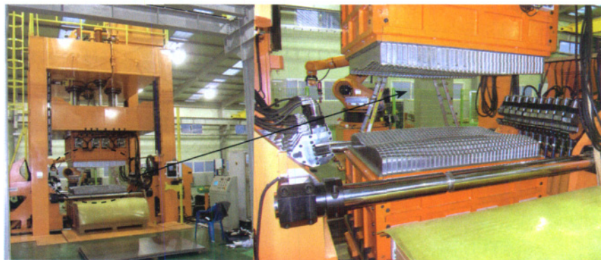
图4 多点拉形与对压复合成形机
