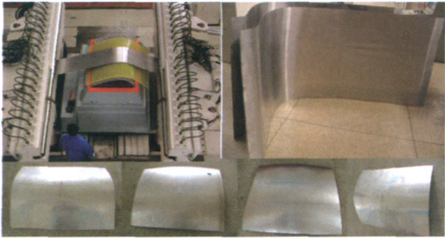
图5 多点数字化调形装置的应用
