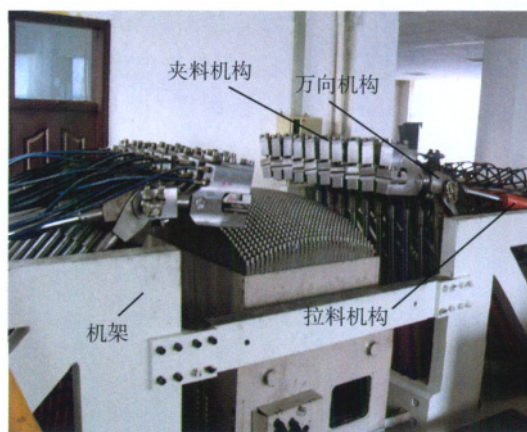
图3 SF-1200型多点柔性拉伸成形机
