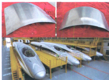
图7 多点拉伸成形的高速列车蒙皮
